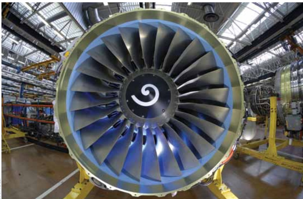
un moteur CFM 56, à savoir celui qui vole actuellement sur la majorité des Airbus A320 et des B737 dans le monde. Techspace Aero fournit les compresseurs basse pression de ces moteurs
